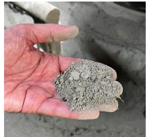
Abbildung 1: UHFB-Premix, bestehend aus Feststoffen und Kurzfasern, vor Zugabe von Wasser und Fließmittel (Foto: MKP GmbH 2023)
