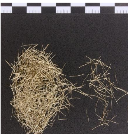
Abbildung 2: Beispiel für verwendbare Stahlfasern mit 13 mm Länge und 0,2 mm Dicke (Foto: MKP GmbH 2023)
