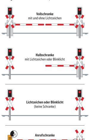
Diese Schranke wird erst über einen "Anruf" bei dem Fahrdienstleiter geöffnet und nach Überquerung wieder verschlossen.
